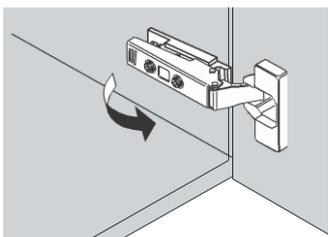
Attraper la charnière par le "clapet" arrière et tirer vers l'avant (Ne jamais démonter l'embase)
