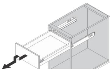
Tirer, à la butée suivre le mouvement de la flèche ci-dessus, tirer à nouveau
